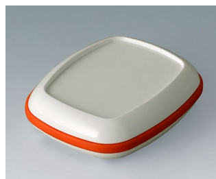
B1604207 BODY-CASE M, mit Vertiefung ASA (UL 94 HB) verkehrsweiß RAL 9016 50x41x16mm IP 65
