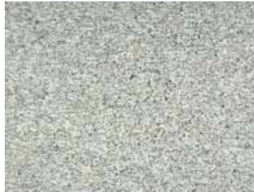
Nitinol-Rohre Innenoberfläche Slurry Cleaning
