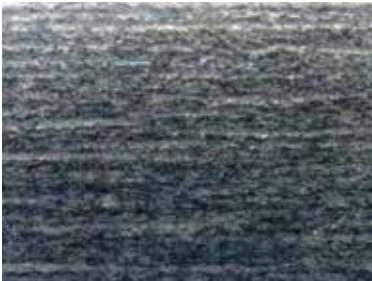
Nitinol-Rohre Innenoberfläche oxidisch
